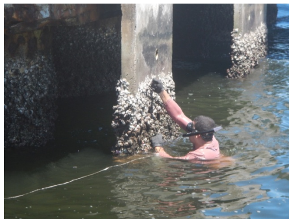
Figura 6 - Coleta de espécimes no pilar da Ponte Rio-Niterói.
