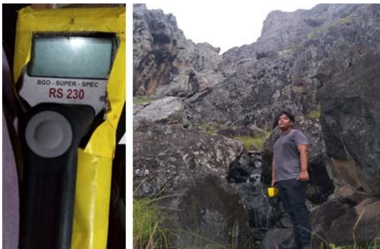
Figura 9: a) Foto do RS-230® (RADIATION SOLUTION INC.) (b) Foto mostrando o processo de medida dos elementos radioativos superficiais utilizando o espectrômetro Gama portátil.
