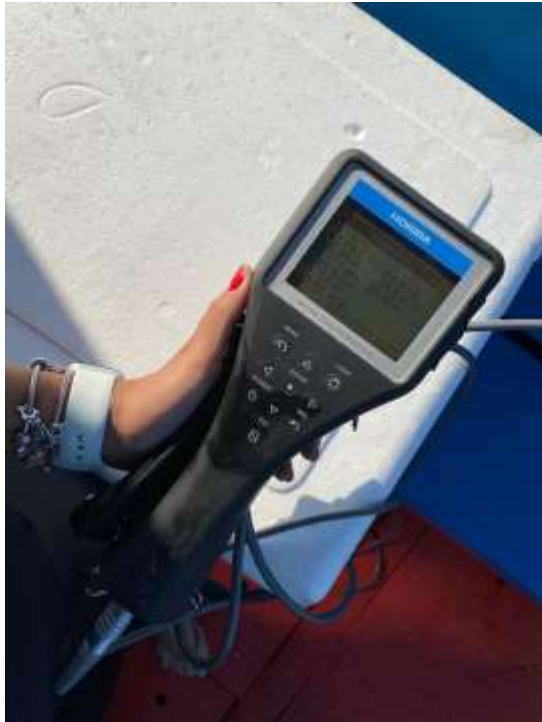
Figura 6- Detalhe da sonda Horiba U50 para verificação das variáveis físico-químicas. Fonte: autora
