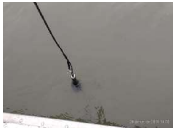
Figura 9- Detalhe do sensor para aferir as variáveis físico-químicas. Fonte:autora
