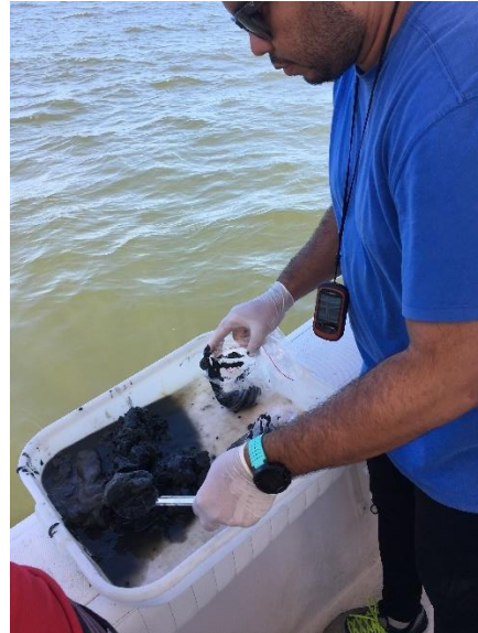
Figura 10 – Coleta de amostra de sedimentos para análise de nutrientes – ponto 6.
