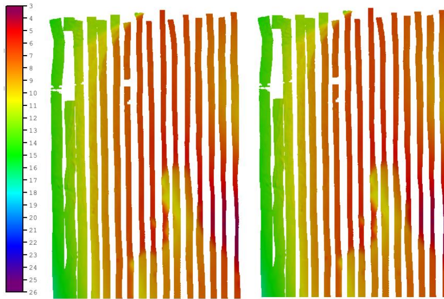
Figura 105 – Camadas da superfície MBES. A da esquerda é a camada Shoal, a da direita é Shoal HR . Escala em metros.
