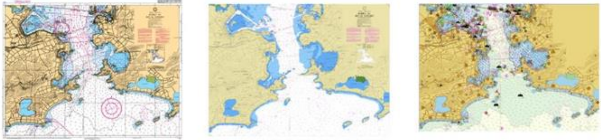
Figura 4 – Carta Náutica 1511, nos formatos papel, raster e vetorial. Fonte: (MANDARINO et al., 2017). Esse é um exemplo do atual portfólio mantido e oferecido pela DHN.
