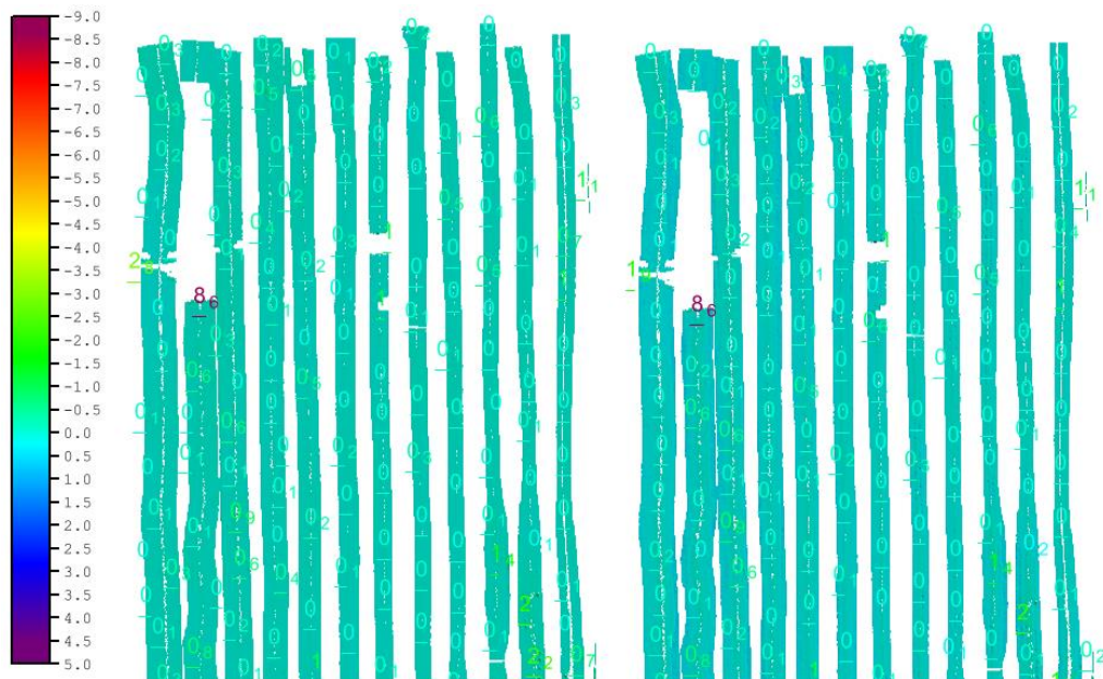
Figura 109 – Superfícies diferença. A da esquerda é Shoal_{MBES} - Shoal_{HP/PDBS} . A da direita é Shoal_{MBES} - Shoal_{PDBS} . Escala em metros. Os dígitos funcionam como uma seleção de sondagens, mostrando os pontos onde as diferenças possuem maior valor.
