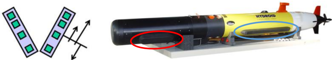
Figura 17 – Na esquerda, a disposição dos elementos em uma visão frontal. Nele pode-se ver o transmissor e os diversos pares de receptor espaçados em diferentes distâncias. Fonte: CLARKE (2013a). Na direita tem-se o equipamento montado em um AUV REMUS 100S da Empresa Kongsberg Maritime. Nele, o transdutor mais de ré é de um sidescan sem interferometria (dentro do círculo azul). O que está à frente (dentro de um círculo vermelho) é o Geoswath Plus, um sidescan sonar interferométrico. O array é disposto no sentido do deslocamento do equipamento. Fonte: adaptado de KONGSBERG MARITIME (2015).
