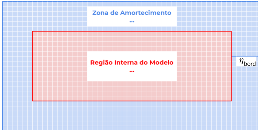
Figura 33 – Ilustração de uma Zona de Amortecimento. Em vermelho é delimitada a região do modelo e em azul a Zona de Amortecimento, a extensão desta zona se dá em função do número de pontos além da malha do modelo \eta_{bord} .
