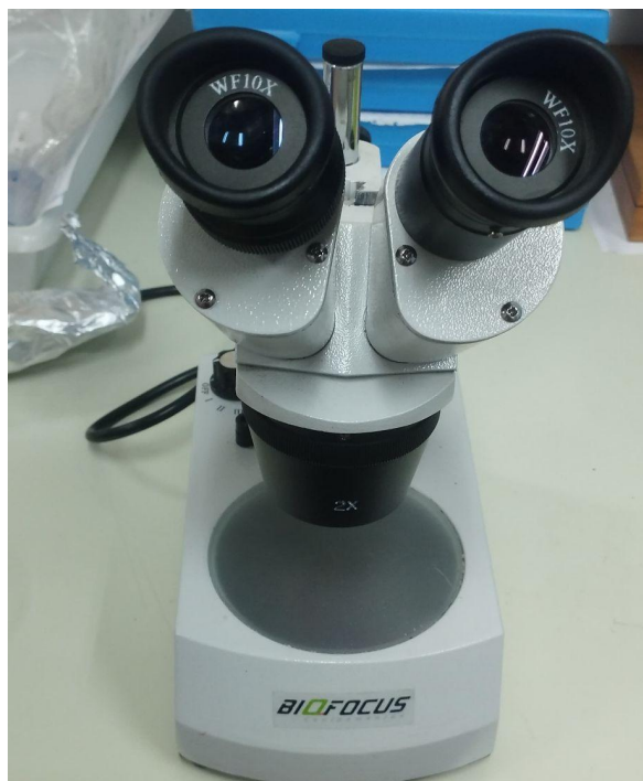
Figura 10: Microscópio binocular estereoscópio (20x e 40x) utilizado para contagem e classificação de microplásticos.
