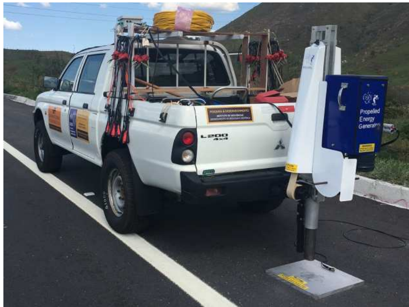
Figura 28 – Fonte sísmica: Peso acelerado que colide com a placa metálica em superfície conetada a uma caminhonete. Fonte: Autor.
