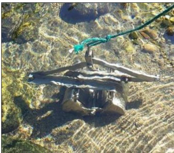
Figura 2- Amostragem de sedimentos de fundo a partir da draga Van Vem
