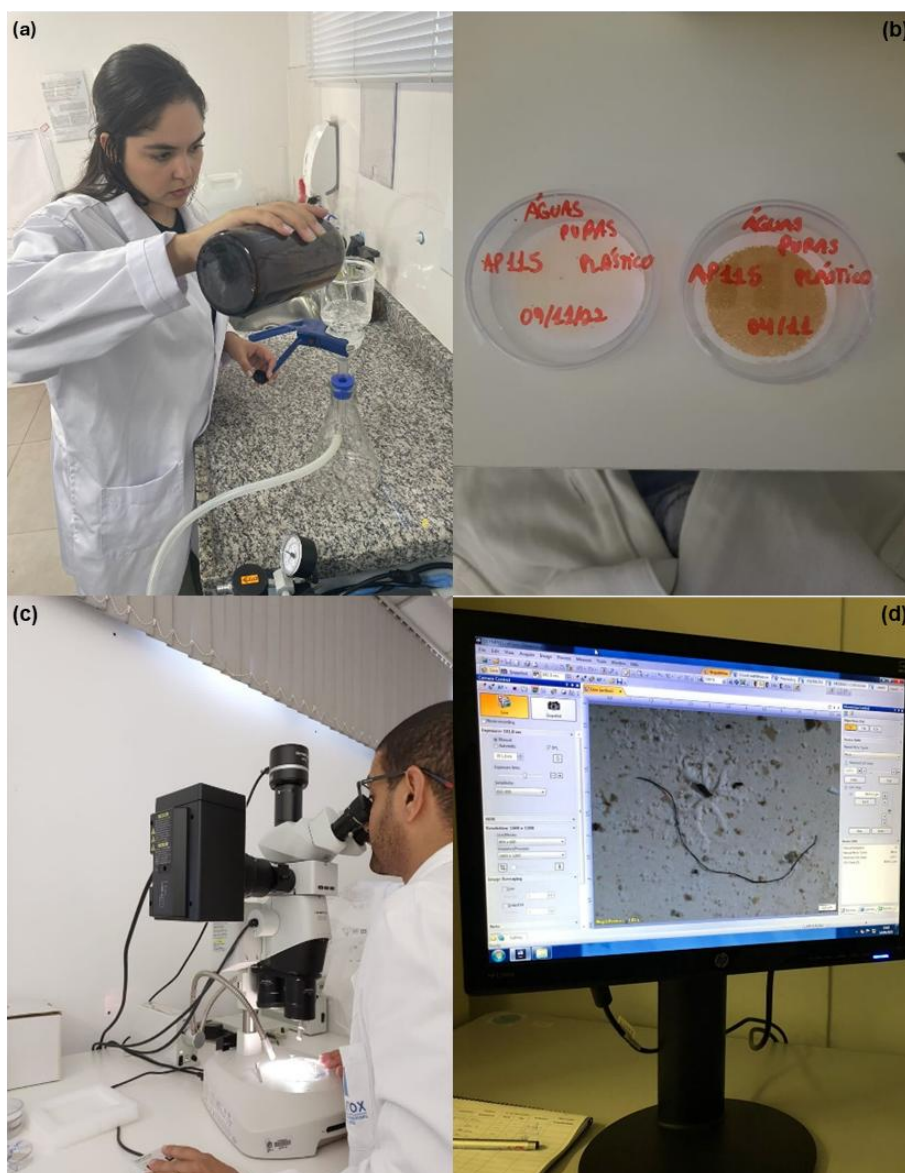
Figura 5 – Processo de caracterização das amostras: (a) filtragem da água; (b) armazenamento das amostras filtradas em placa de Petri identificadas; (c) Microscópio Olympus SZX16; (d) imagem gerada pelo microscópio SZX16.
