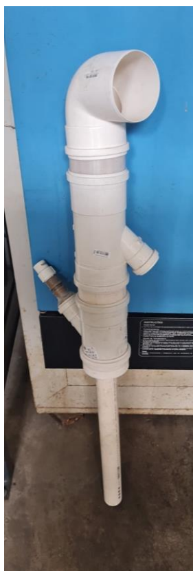
Figura 1.111 - Versão do PULMÃO a partir de tubos de PVC. (Foto do autor).
