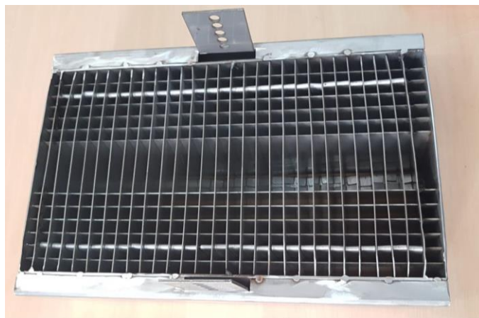
Figura 1.5 - Colméia de aço inox. (Foto do autor)
