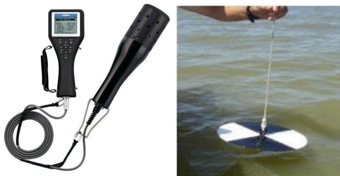
Figura 4.3 - Sonda multiparamétrica modelo Horiba U-50 e disco de Secchi
