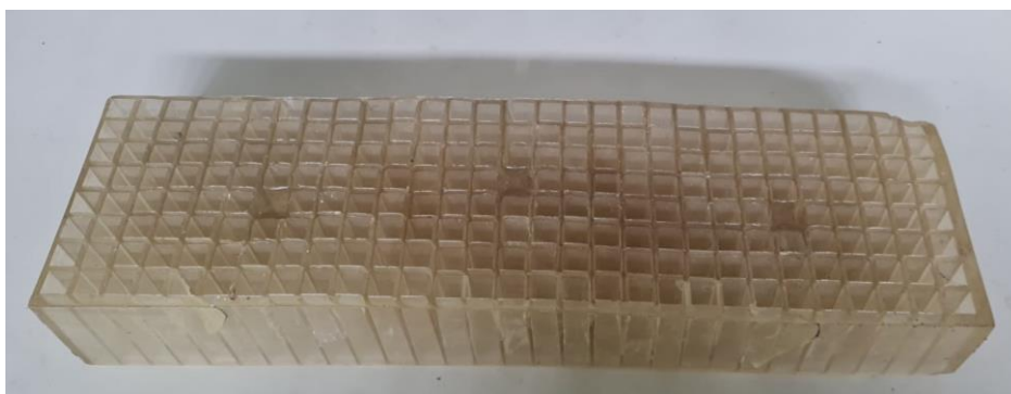
Figura 1.12 - Colmeia fabricada com resina. (Foto do autor).
