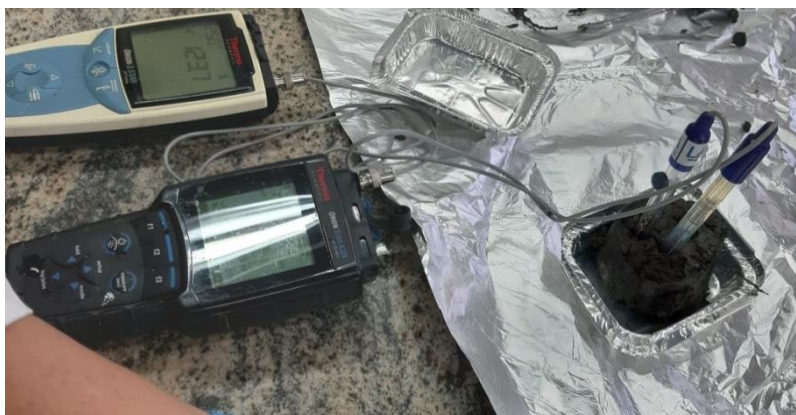
Figura 23 – Medição de Eh e pH de camada de testemunho de sedimento
