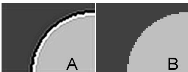
Figura 20 - Efeito do ringing (A) sobre uma transi o brusca de sinal (B)
